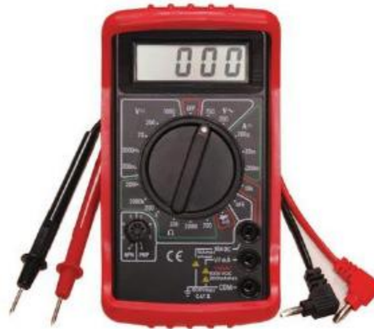
Figura 2. Voltímetro digital equipado con electrodos de puntas “roma”.
