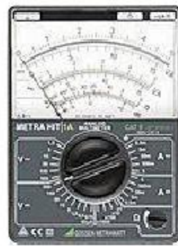
Figura 1. Voltímetro electromecánico, también conocido como analógico.
