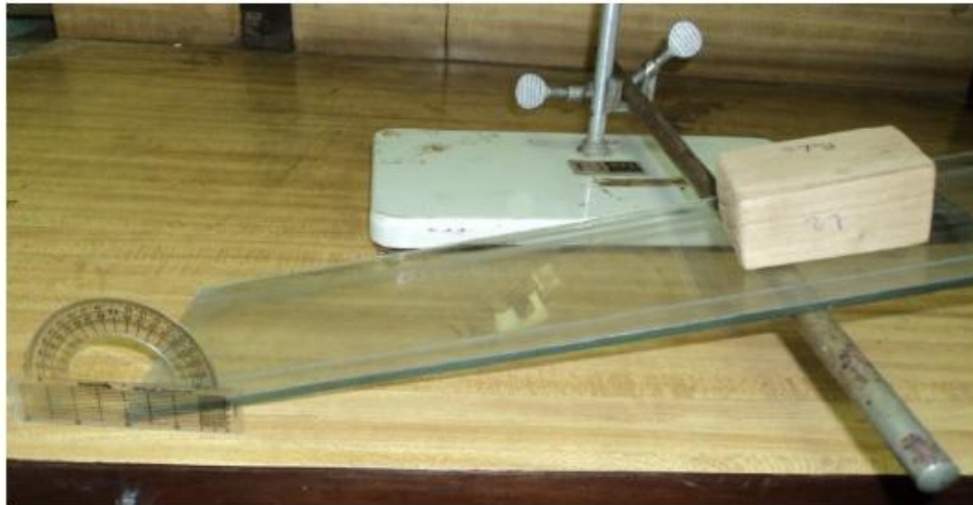
Figura 2 Montaje experimental para medir el coeficiente de fricción estático
